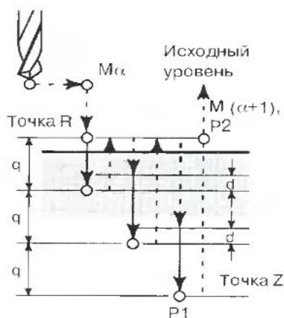
Рисунок 4 - Цикл сверления с периодическим выводом сверла.
