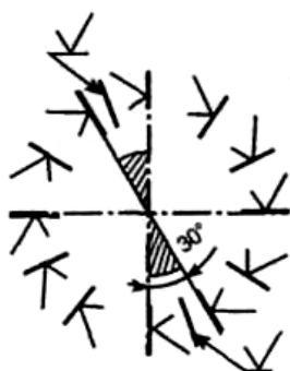
Рисунок 21 – Обозначение шероховатости на размерных линиях
