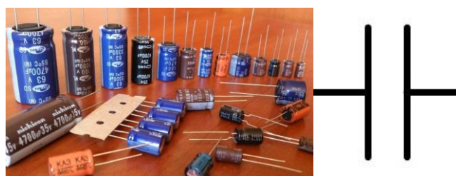
Рисунок 3 – внешний вид и условно графическое обозначение конденсаторов
