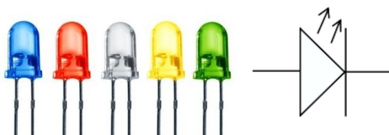
Рисунок 7 – внешний вид и условно графическое обозначение светодиодов Это полупроводниковое устройство, создающее излучение при прохождении через него электрического тока. У светодиода бывает два состояния: закрытое и открытое. Закрытое состояние – состояние, при котором через диод не течет ток (на самом деле ток течет, но очень малый порядка нескольких мкА). Открытое состояние – состояние, при котором через диод течет ток;
