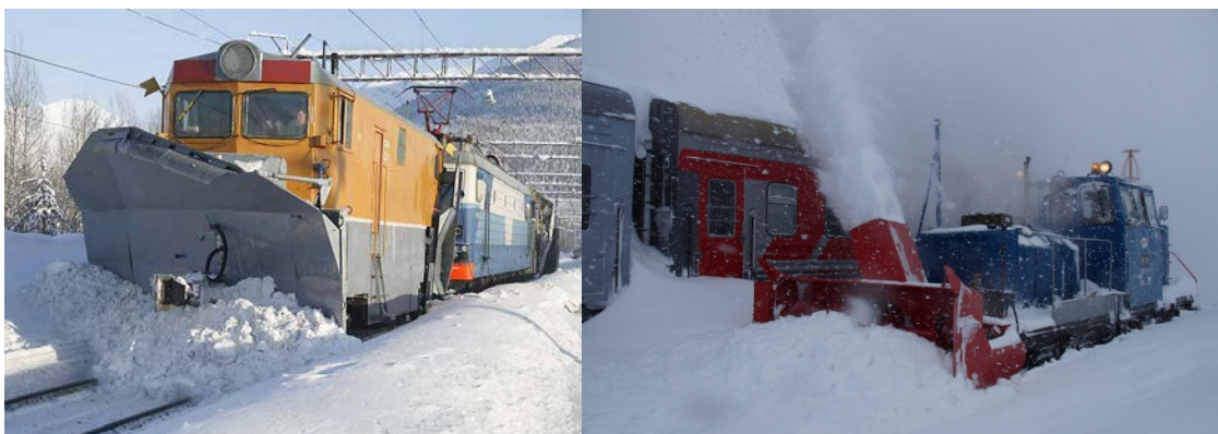
Рис. 1 Виды навесного оборудования для очистки железнодорожных путей (плужный и фрезерно-роторный).
