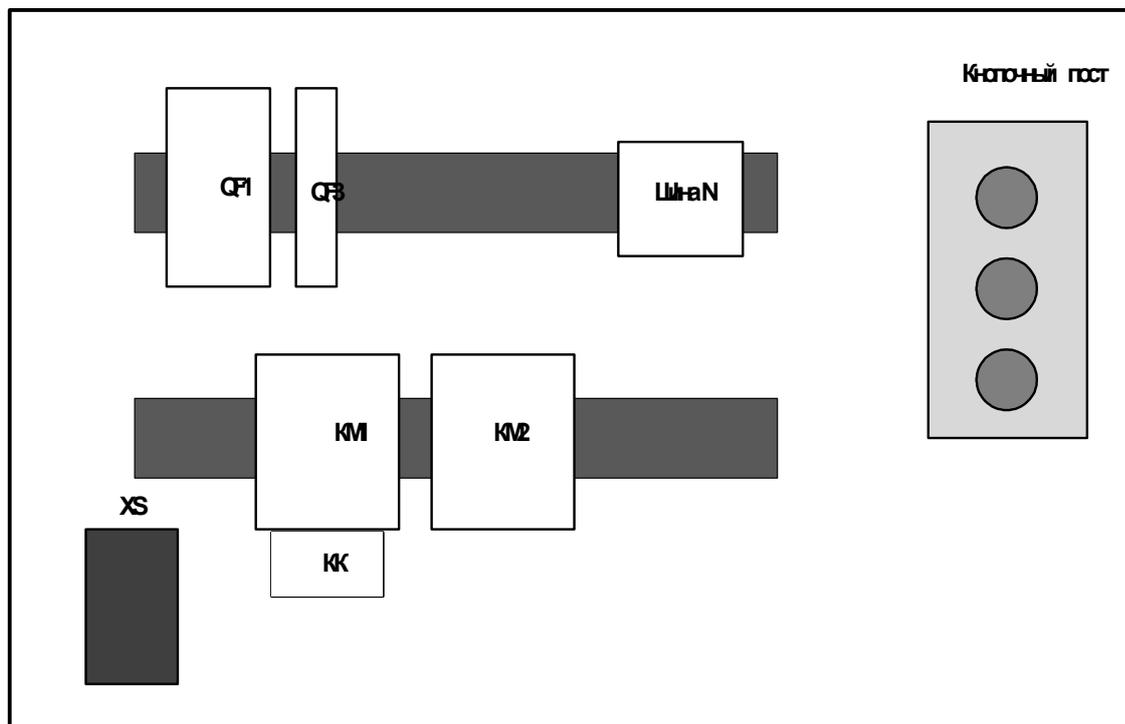
Схема реверсивного пуска асинхронного двигателя
